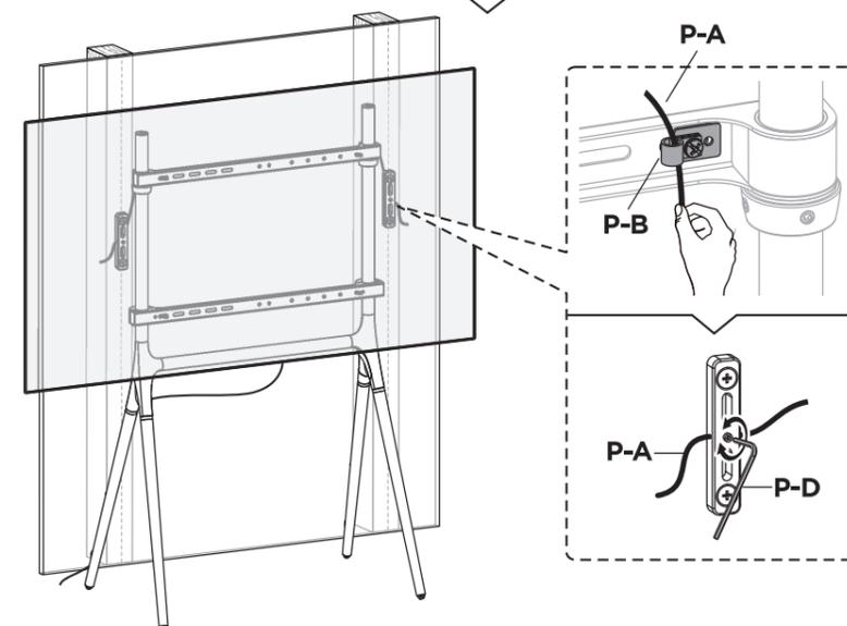
DISPLAY / TVの転倒・落下防止のため、安全キットの取付けを推奨します。
