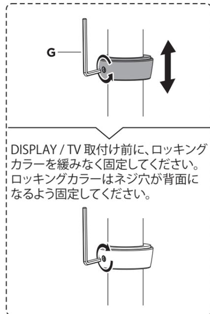
DISPLAY / TV 取付け前に、ロックングカラーを緩みなく固定してください。ロックングカラーはネジ穴が背面になるよう固定してください。
